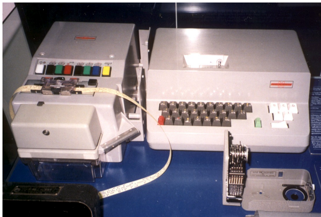
Abb. 8: Auch nach dem Krieg wurden, bevor allgemein Computer Verwendung fanden, noch Verschlüsselungsmaschinen neu entwickelt. Das Bild zeigt ein Rotor-Chiffriergerät mit Zusatz-Lochstreifengerät der Bauart Hagelin-Cryptos Type H (hergestellt von 1963 bis 1965) und ein kleines Taschenchiffriergerät vom Typ Hagelin-Cryptos CD-57. Diese Nachkriegsentwicklungen werden hier jedoch nicht besprochen.
