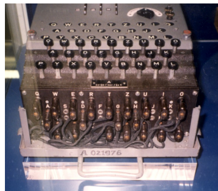
links: Abb. 6: Die Enigma in der Marine-Ausführung mit 4 Walzen und Holzkiste zum Aufbewahren der empfindlichen Austauschwalzen
